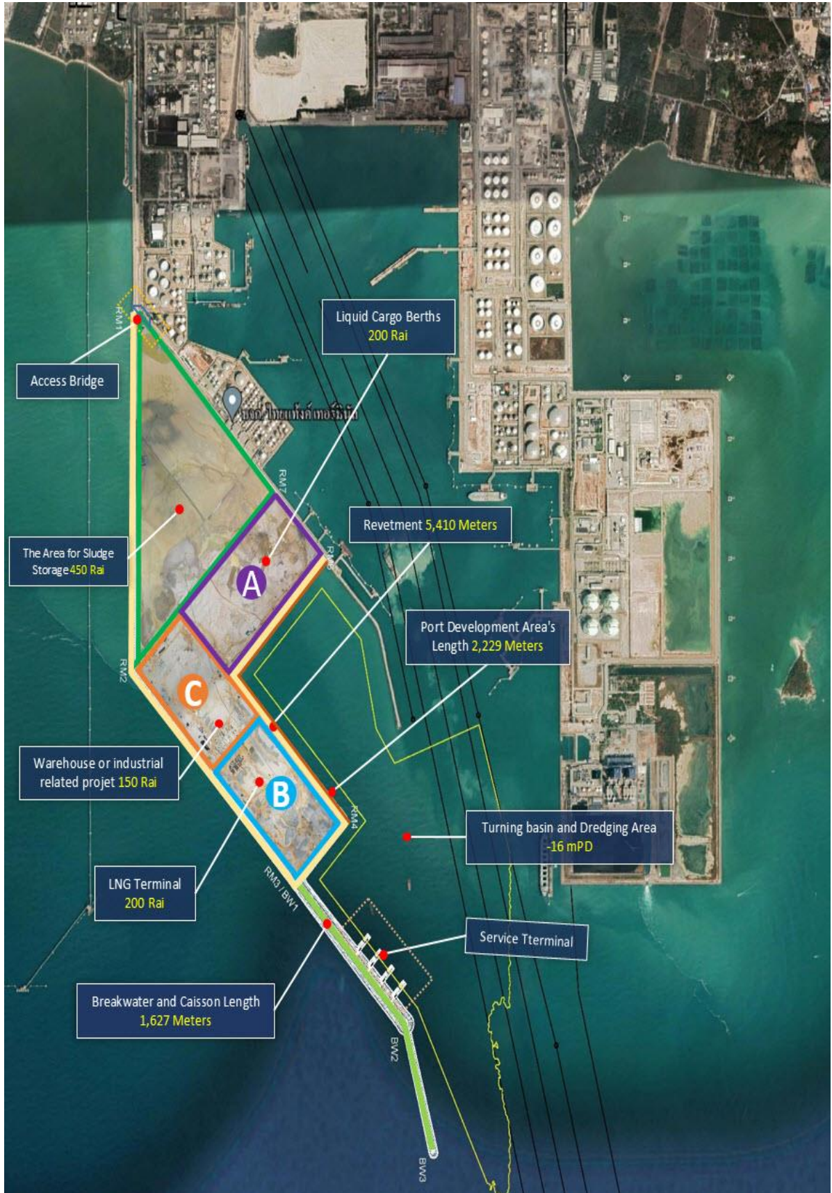
รูปที่ 1-1 รายละเอียดโครงการพัฒนาท่าเรืออุตสาหกรรมมาบตาพุด ระยะที่ 3 ช่วงที่ 1
